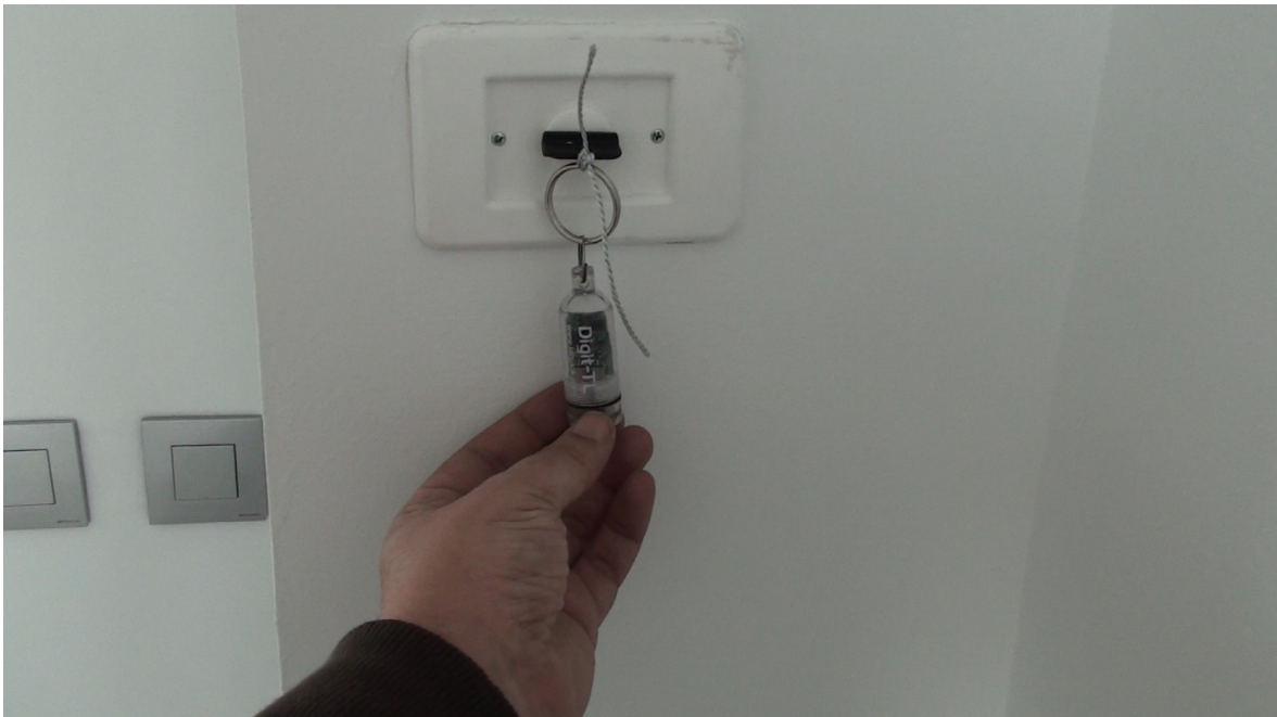
Detalle del termómetro LabJack Digit-TL instalado en la planta alta de la vivienda
